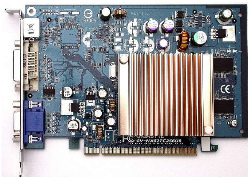
Рис. 3.49 – Відеокарта з роз'ємом PCIe
