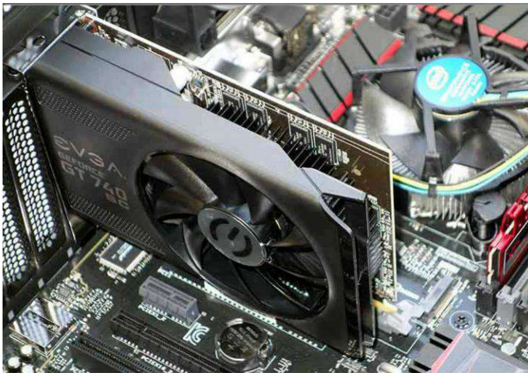
Рис. 5.6. – Установка плати відеоадаптера
