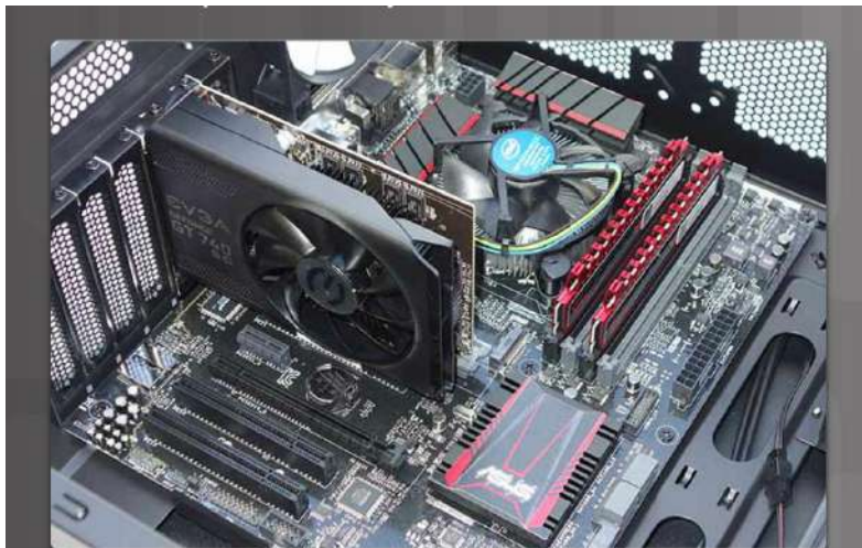
Рис. 3.33 – Материнській плата з встановленими компонентами
