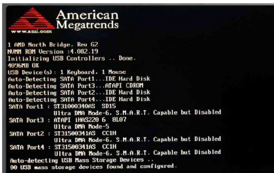
Рис. 5.20 – Процедура POST – перевірка основних компонентів комп'ютера
