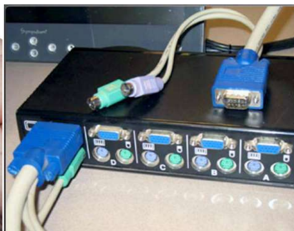
Рис. 3.75 – KVM-перемикач (Keyboard, video, mouse switch)
