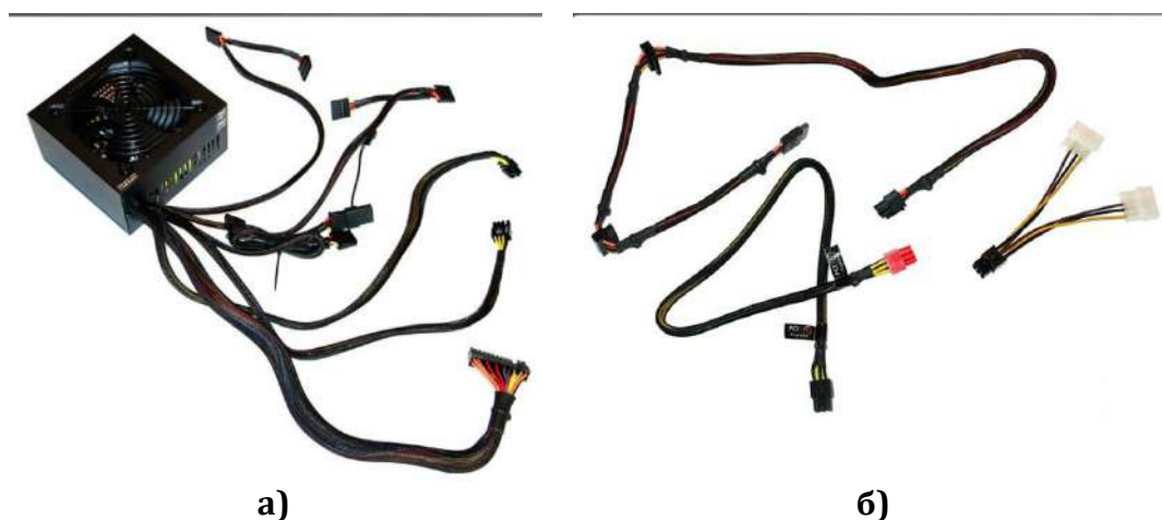
Рис. 5.1 – Блок живлення а) та готова розводка кабелів б)
