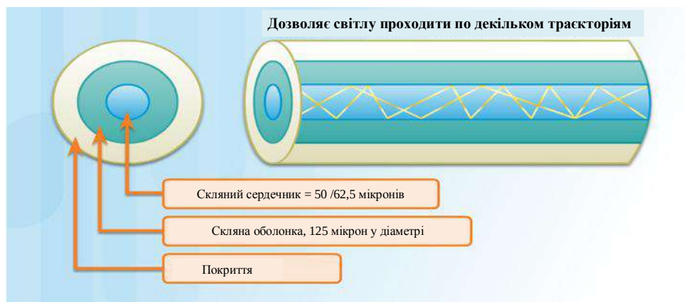
Рис.6.40 – Багатомодовий кабель
