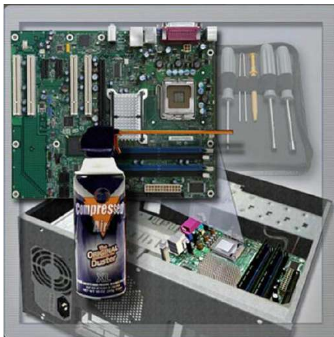
Рис. 5.42 – Використанні стисненого повітря з балончика
