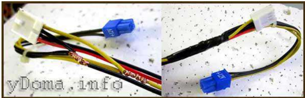
Рис. 3.15 – Підготовка проводів, що йдуть від роз'ємів
