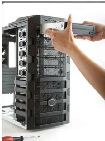
Рис. 5.3 – Установка привода оптичних дисків
