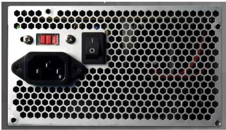
Рис. 3.6 Задня панель блоку живлення
