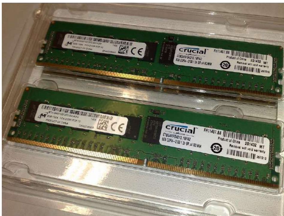
Рис. 3.43 – Пара планок пам'яті 8 GB DDR4-2133 ECC 1.2 V
