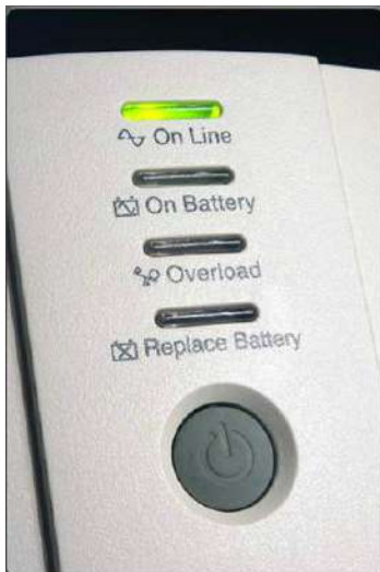
Рис. 4.5 – Панель управління ДБЖ
