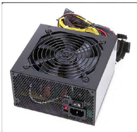
Рис. 3.4 – Блок живлення комп'ютера
