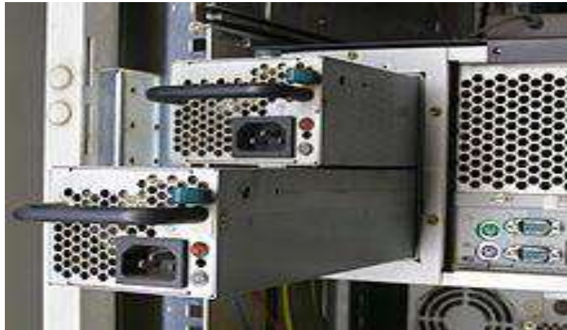
Рис. 2.43– Резервування блоку живлення (дублювання).
