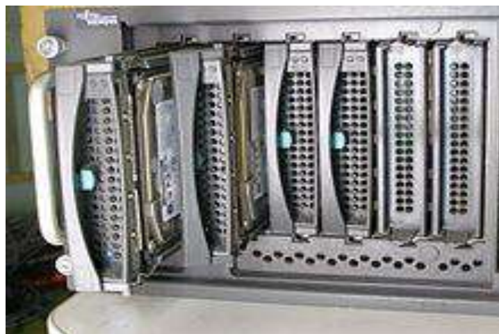
Рис. 2.45– Резервування жорстких дисків
