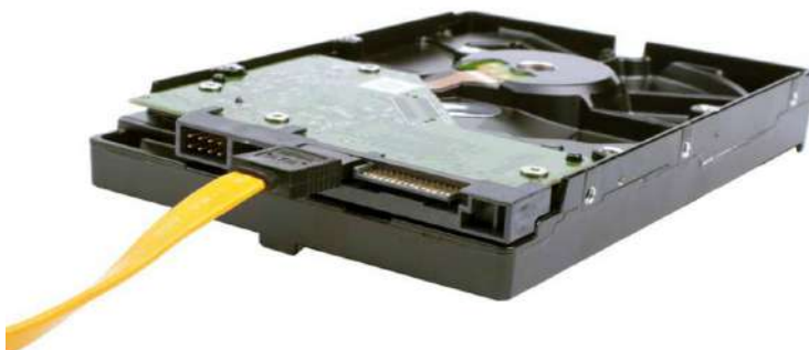
Рис. 5. 11 – Підключення внутрішніх жорстких дисків і приводів оптичних дисків до материнської плати
