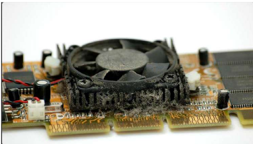
Рис. 4.23– Скупчення пили на вентиляторі відеокарти.
