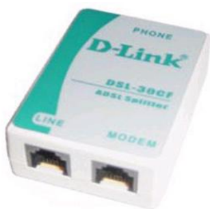
Рисунок 2.14 – Варіант розгалуження для телефонних кабелів (D-link DSL-30CF/RS Сплітер ADSL)
