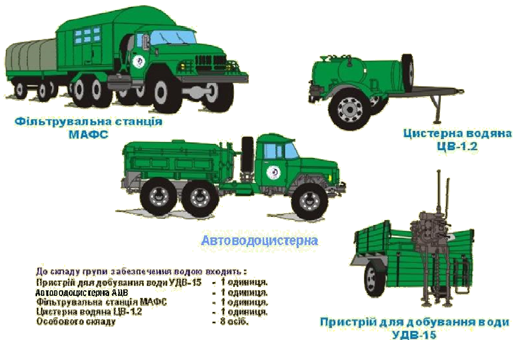
Рис.15. Обладнання групи забезпечення водою
